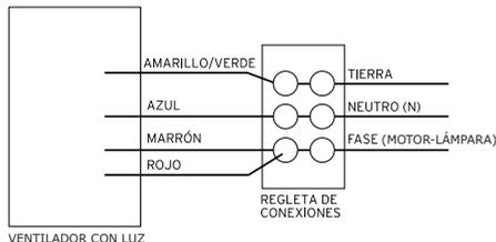
Conecte los cables del techo a la regleta de conexiones. Marrón a la fase, Azul al neutro, Rojo a la instalación de la lámpara de su modelo de ventilador y Amarillo/Verde al tierra.
