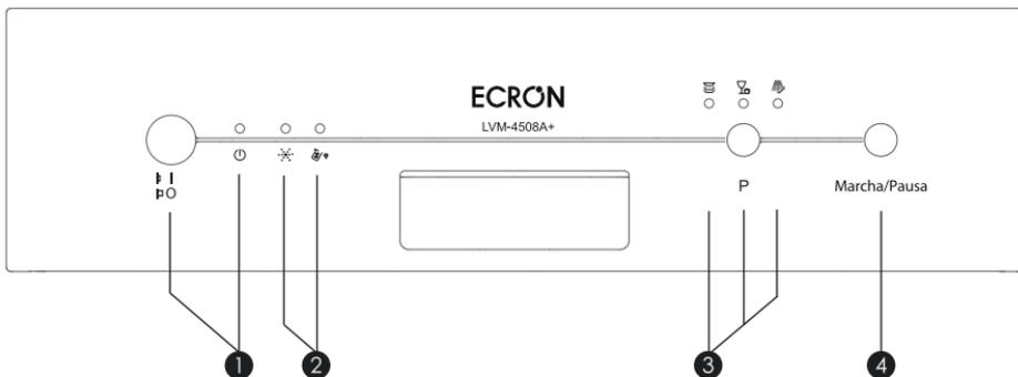
**1.** Luz piloto de corriente e interruptor: para encender y apagar, y mostrar la corriente.
