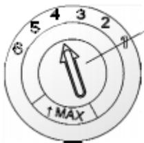
Una cantidad medida del abrillantador se libera durante el aclarado final. Como con el detergente, la cantidad de abrillantador necesaria para los platos depende de la dureza del agua de la zona. Demasiado abrillantador puede derivar en
