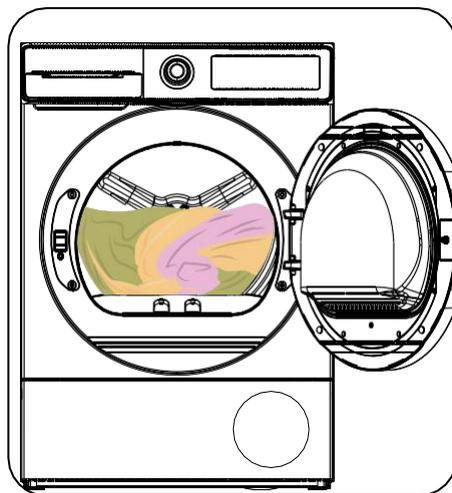
**IMPORTANTE:** No se recomienda cargar la secadora con más ropa de la que se muestra en la figura. Cuando se sobrecarga, el rendimiento de secado de la secadora disminuye, y la secadora y la ropa podrían dañarse.
